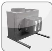
Das doppelschalige Gehäuse besteht aus verzinktem Stahlblech und ist innen mit nichtbrennbarer Steinwolle gegen Schall und Feuchtigkeit isoliert. Durch die ausschwenkbare Ventilatereinheit ist ein einfacher Zugang zum Gehäuseinneren gewährleistet, wodurch eine schnelle und effiziente Reinigung möglich ist. Im Gehäuse ist ein Aerosolablauf mit Außengewinde eingebaut.
