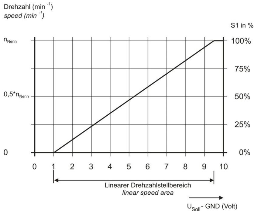
Der Drehzahlsollwert lässt sich durch ein angeschlossenes Potentiometer (S1 / 10 k $\Omega$ ) von einer Minimalsdrehzahl (ca. 5%) bis 100% stufenlos einstellen. Das gleiche gilt für die Drehzahlstellung durch ein externes 0 – 10V Signal.
